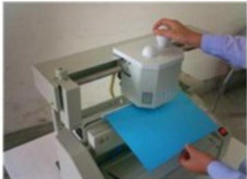
6. Jalando ligeramente la tapa anterior, pase una o dos veces de ida y vuelta, el aplicador de adhesivo termofundible (hot melt ) sobre la superficie del lomo. No deben quedar surcos.
